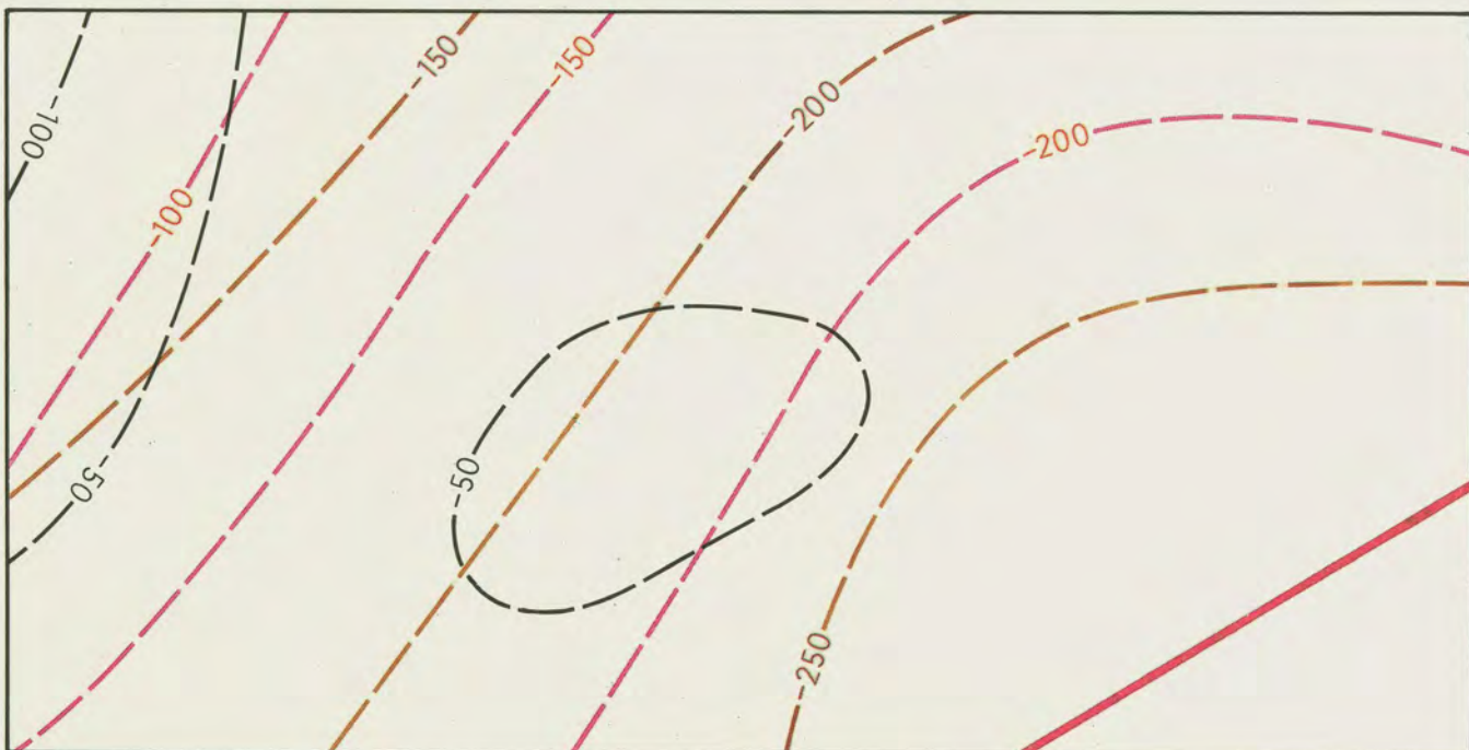
Abb.3.5: Hangend- und Liegendflächen [m NN], Versalzung und tektonische Störung
