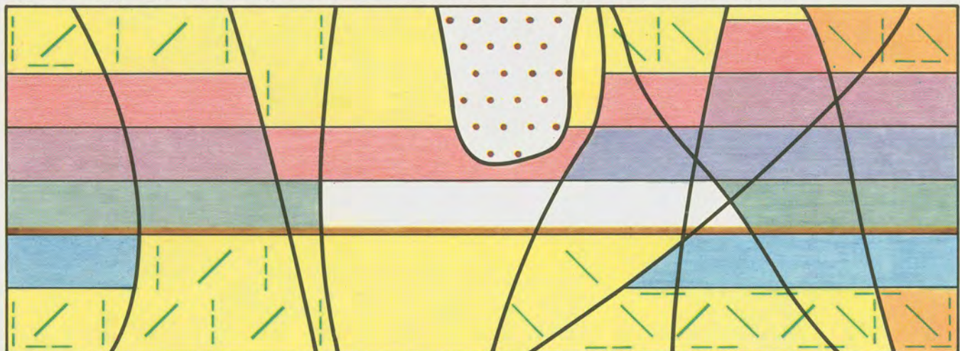
Abb. 5.3: Regional differenzierter, lithofazieller Aufbau im Horizontalschnittbalken mit k-Wert-Angaben
